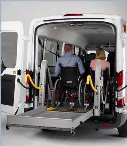
Das weltweit einzigartige Design der spezialgefertigten Hubarme verdankt der AL1 dem Einsatz von Aluminiumprofilen.
