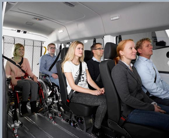
Durch den Smartfloorboden ist die flexible Beförderung von „Läufern“ und Rollstuhlnutzern kein Problem.
