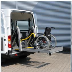
Über den Lift gelangt der Rollstuhl sicher in das Fahrzeug.
