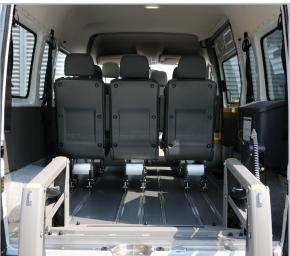
Durch den Smartfloor Systemboden ist die flexible Beförderung von Personen mit und ohne Rollstuhl möglich
