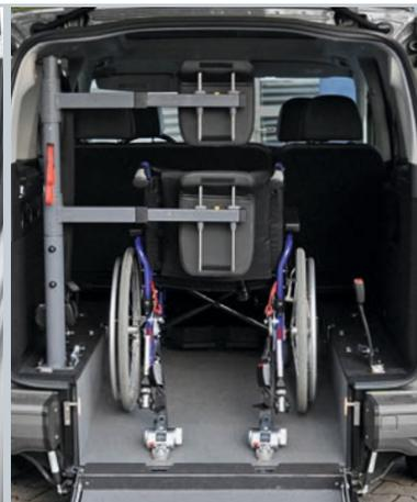
Das Fahrzeug kann mit der Kopf- und Rückenstütze **FUTURESAFE** ausgestattet werden.
