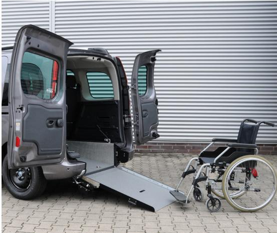
Bei ausgeklappter Rampe ist das Fahrzeug mit dem Rollstuhl befahrbar.
