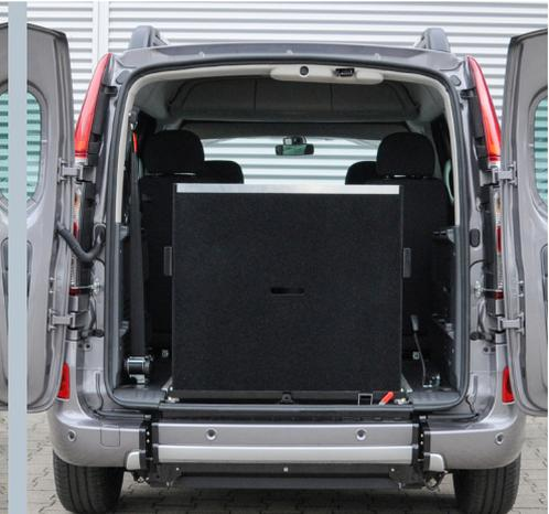
Abfahrbereites Fahrzeug mit eingeklappter Rampe.
