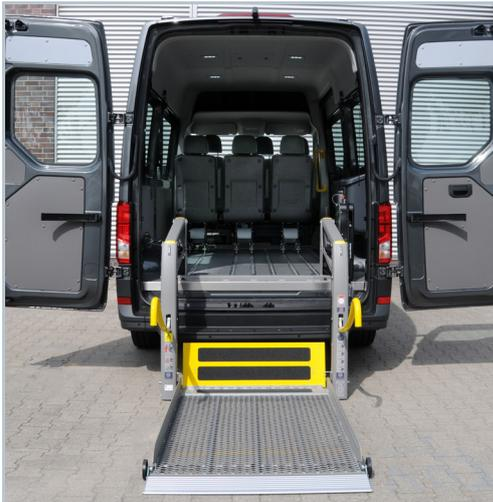
Über den Lift gelangt der Rollstuhlfahrer sicher in das Fahrzeug.
