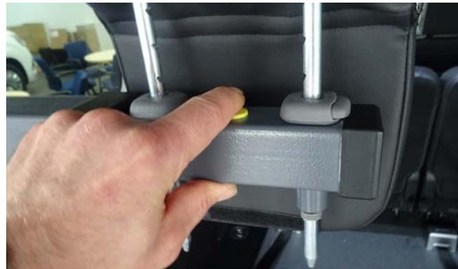
2. Schieben Sie den äußeren Teil des Schwenkarms bei gedrücktem Seiten-Entriegelungsknopf in die gewünschte Position.
