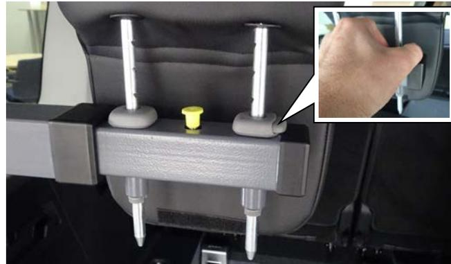
2. Drücken Sie die Kopfstütze oder die Rückenlehne bei gedrücktem Höhen-Entriegelungsknopf bis in die gewünschte Position nach unten.
