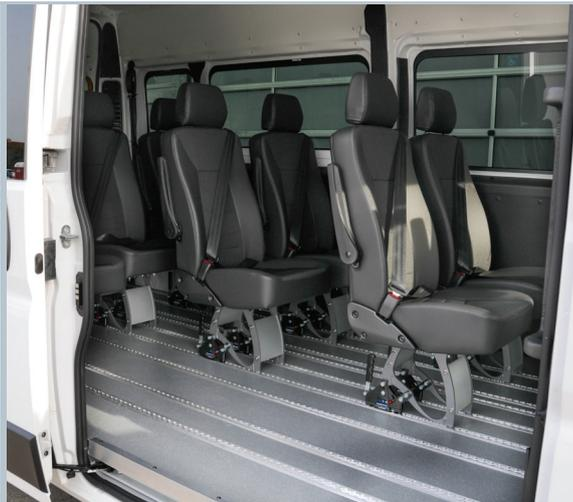
Der SMARTFLOOR Systemboden ermöglicht eine flexible Beförderung von Personen mit und ohne Rollstuhl.
