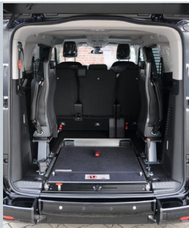
Die eingeklappten **EASYFLEX** Rampe ermöglicht die volle Nutzung des Kofferraums.
