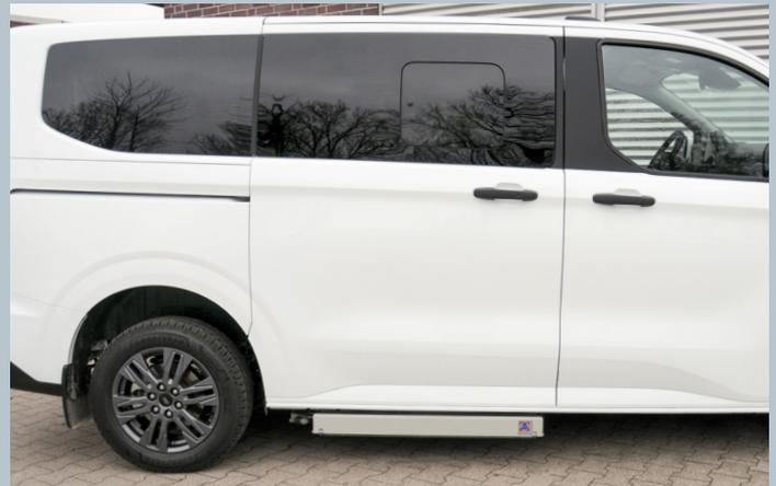
Der ultraflache Kassettenlift K70 bietet bestmögliche Bodenfreiheit.
