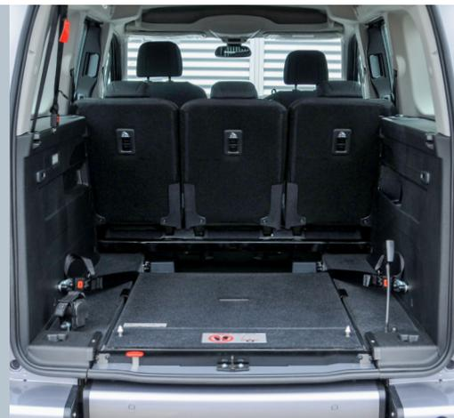
Die eingeklappte EASYFLEX Rampe ermöglicht die volle Nutzung des Kofferraums.
