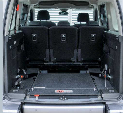
Mit der eingeklappten EASYFLEX Rampe kann der Kofferraum voll genutzt werden.
