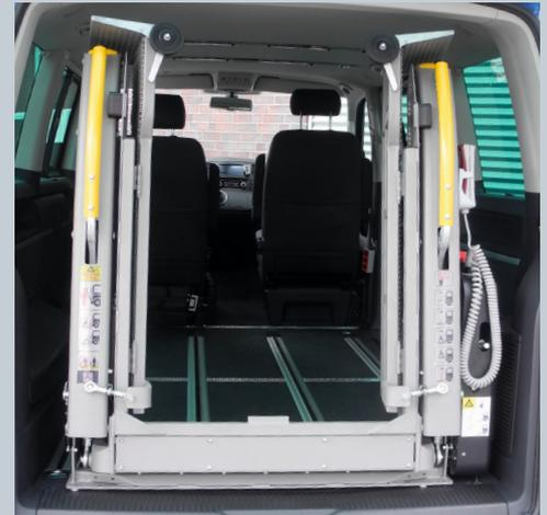
Die Split-Plattform sichert eine freie Durchsicht nach hinten und ermöglicht den Aus- und Einstieg durch die Hecktür.
