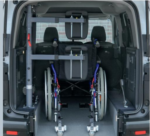
Das Fahrzeug kann mit der Kopf- und Rückenstütze FUTURESAFE 2.0 ausgestattet werden.
