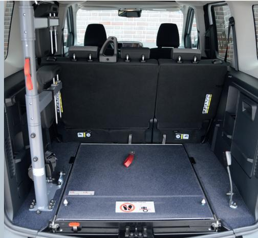
Die eingeklappte EASYFLEX Rampe (optional) ermöglicht die volle Nutzung des Kofferraums.
