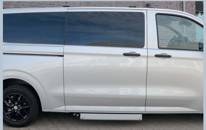
Der ultraflache Kassettenlift K70 bietet bestmögliche Bodenfreiheit.
